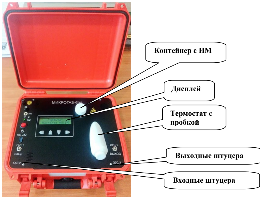
Рисунок 5- Вид лицевой панели мобильной установки динамической «Микрогаз-ФМ»
